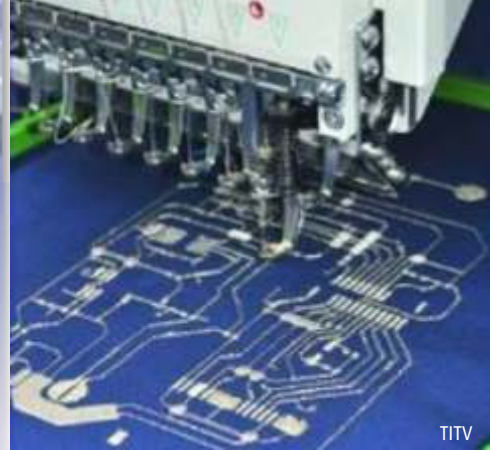
TITV Stitching with conductive yarn/ Stickerei mit leitfähigem Garn
