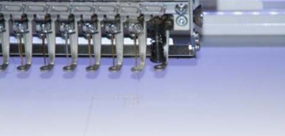
TITV Stitching with conductive yarn/ Stickerei mit leitfähigem Garn
